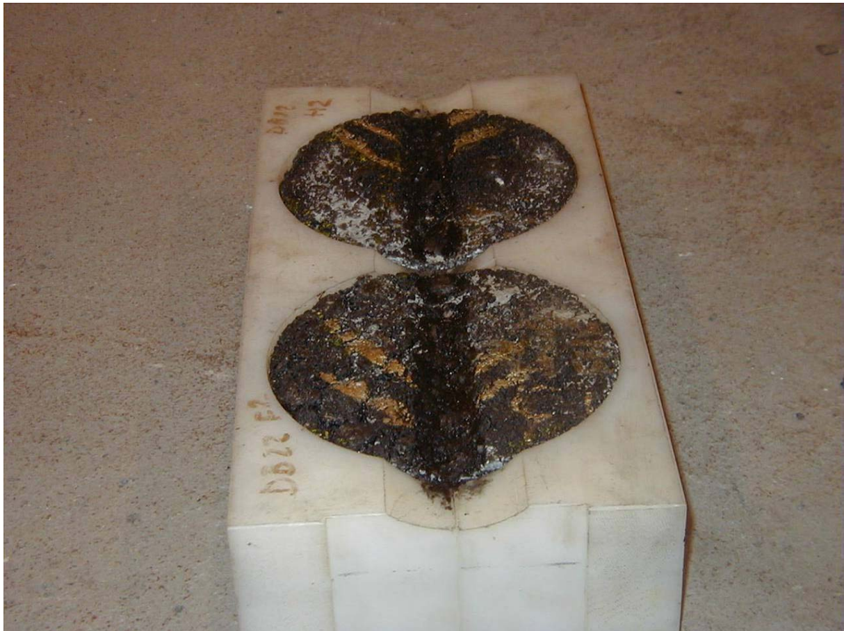
FIGUR 11 Spårdjupsmätningar på balkar och cirkulära provkroppar.
